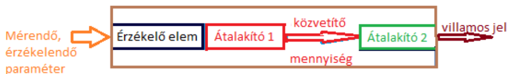
1. ábra Egyszerű érzékelő, „közvetett mérés” 9
