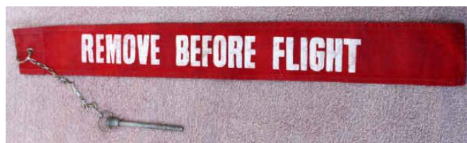
5. kép Biztosítószeget, aminek hiánya okozta valószínűleg a tragédiát [11]
