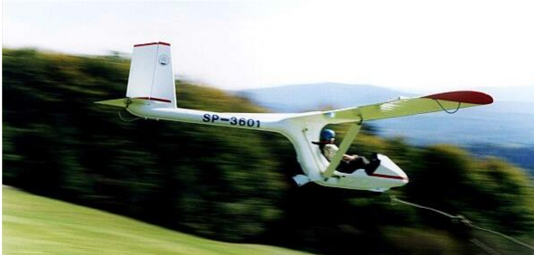
3. ábra A PW-2 GAPA gumiköteles indítása Bezmiechovában [10]
