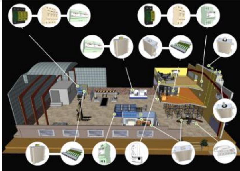
7. ábra Többlépcsős túlfeszültség-védelem [1]
