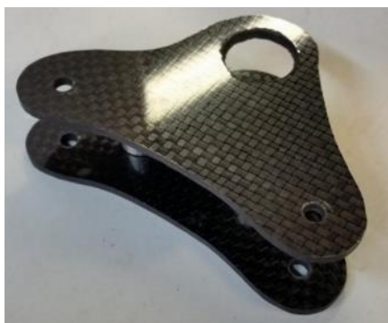
45. ábra Karbon prepregből készült himba laminátum egység
