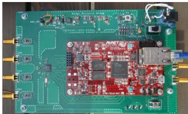
8.ábra Adatgyűjtő és jelfeldolgozó kártya
