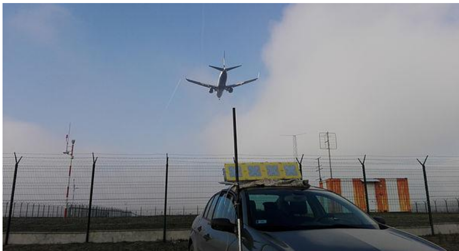
9.ábra Passzív radar vevőegység a demonstrációs mérésen
