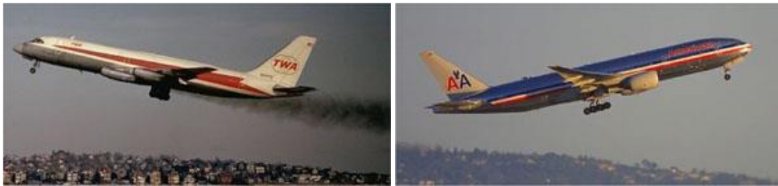
1. ábra Magas koromkibocsátást jelzi a sűrű fekete füst a baloldali képen látható repülőgépen
