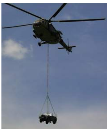
UAZ szállítása külső függesztményként
