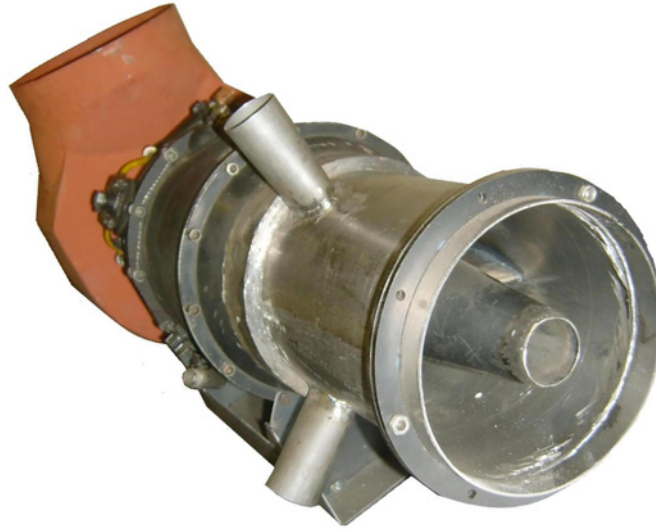
7. ábra: A megvalósított injektoros központi kúppal ellátott fűvócső a hajtóműre építve
