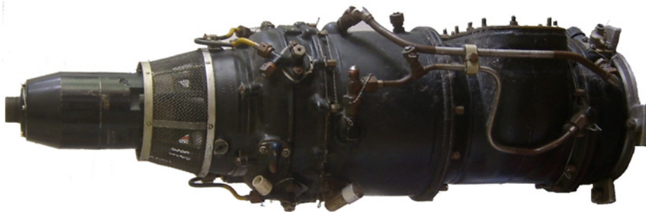
2. ábra: A TSz-21 szabad turbinás indító hajtómű
