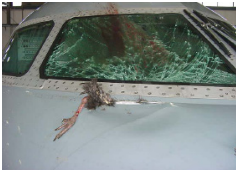
18. ábra Pulyka ütközés következménye a kabinon kívülről (WASHINGTON, 2002.) [6]
