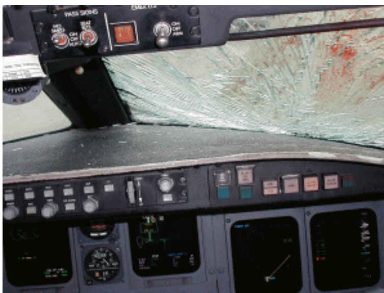
19. ábra Pulyka ütközés következménye a kabinban (WASHINGTON, 2002.) [6]
