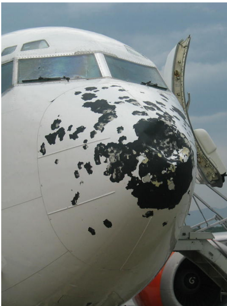
21. ábra Törzs orr-rész ütközés után ( http://flightlevel.20megsfree.com/ )
