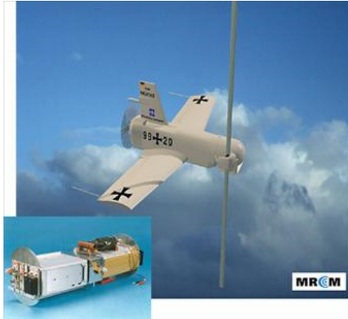
1. kép. A Mücke elektronikai zavaró pilóta nélküli repülőgép
