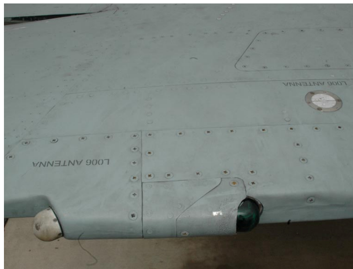
3. ábra A MiG-29 repülőgép L-006 besugárzásjelzőjének antennái a szárny törővégén
