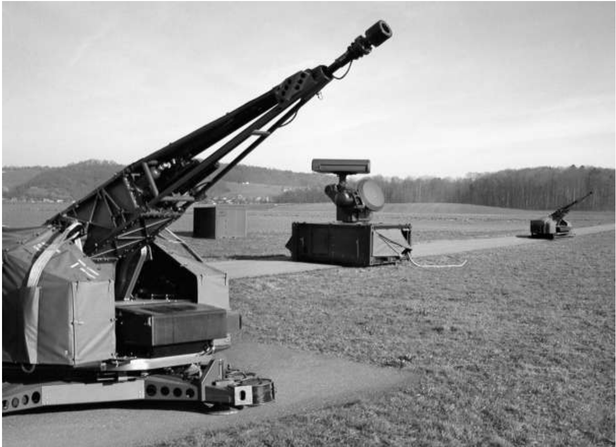
A Skyguard lokátor és a 35 mm-es löveg
