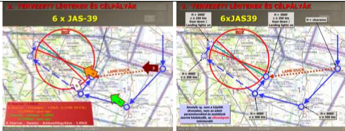
14. ábra JAS–39 GRIPEN repülőgépek tervezett útvonalai és a "DEFECTOR" és "LAME DUCK" eljárások [18] A tűzalegységek által végrehajtott célelfogásokat, tüzeléseket és a zavarás következtében elvesztett célok számát (kiképzési eseményenként) a 8. számú táblázat tartalmazza:
