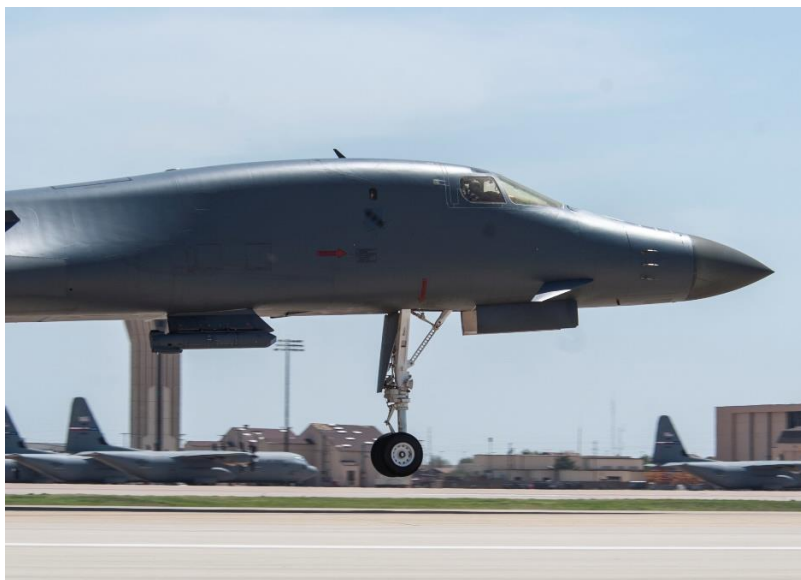
5. ábra: B-1 Lancer bombázó, törzsre rögzített Sniper-SE célfelderítő és célmegjelölő konténerrel 16 .
