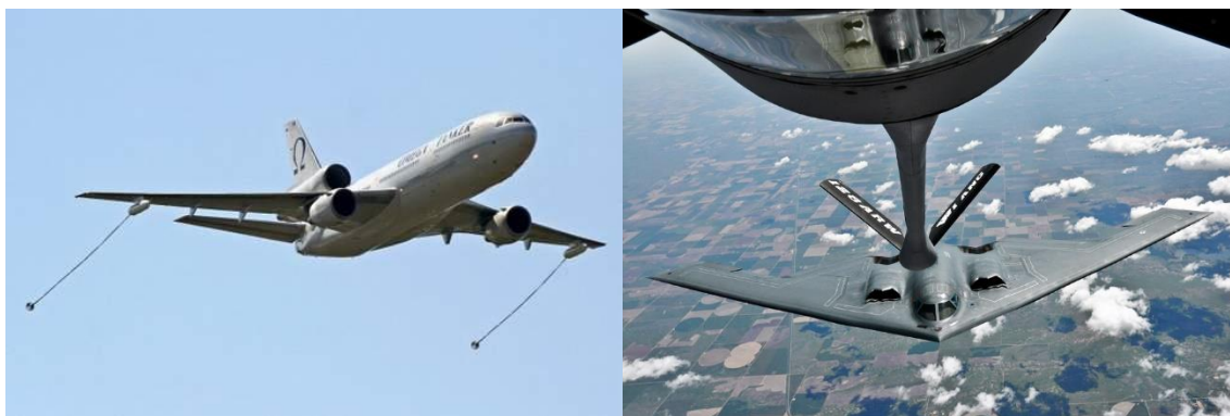
10. ábra: A légi utántöltések során alkalmazott hajlékony 32 és merevsőves rendszer 33 .
