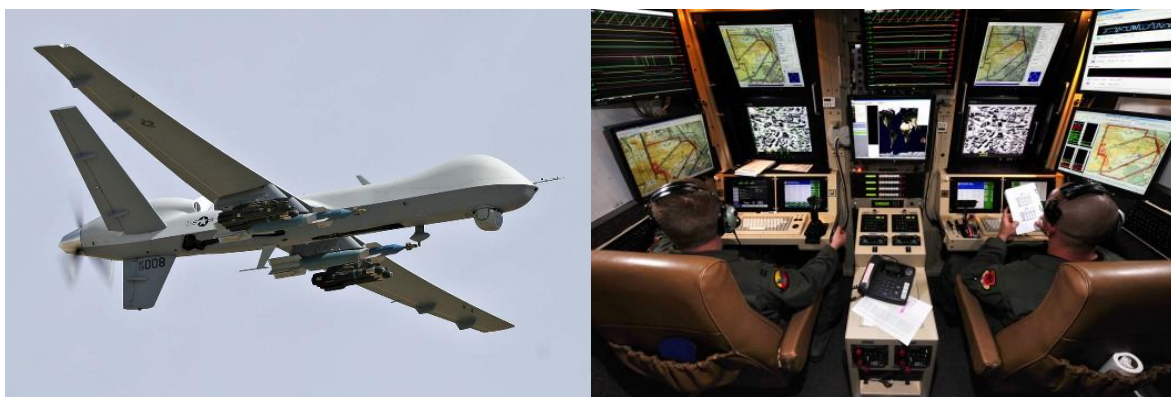
7. ábra: MQ-9 Predator és földi vezérlőállomása 22 23 .
