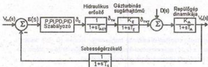
3. ábra Az SSR rendszer hatásvázlata
