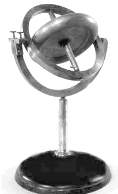
1. ábra. Kardánfelfüggesztésű pörgettyű
