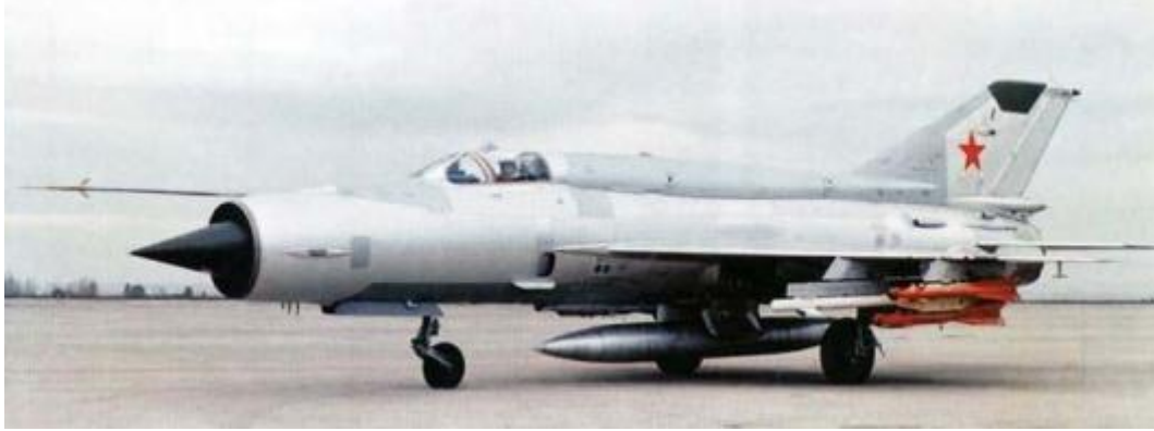
2. ábra MiG-21BISz 2 db R-3Sz és 4 db R-60-as légharc rakétákkal felfegyverezve [4]
