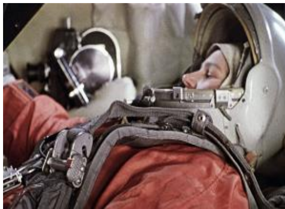
23. ábra Speciális, OSzK típustól eltérő leoldózár Valentyina V. Tyereskova ejtőernyő hevederén. Figyelmet érdemel a kézikiodó-fogantyú [53]
