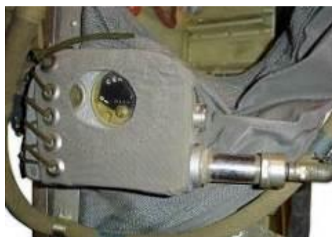
17. ábra KAP-3 típusú nyitóműszer a NAZ-készlet tokkeretéhez... [47]
