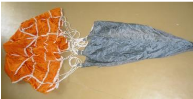
10. ábra A katapultülést a benne ülő kozmonautával együtt stabilizáló, majd a főejtőernyő kihúzását segítő ejtőernyő „unokája” [37]
