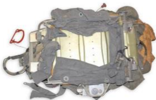
15. ábra A fém hátlapú ejtőernyőtök (a bal oldalon elhelyezett kézi kioldófogantyú nem képezheti a rendszer elemét, ugyanis az egy későbbi, sokak által ismert, kelet-német ejtőernyős eszköz)...
