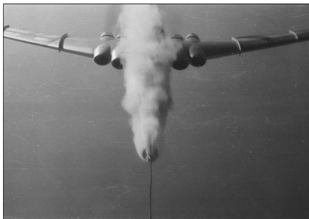
9. ábra A szétkapcsolódás után a tömlő végén elhelyezett zárószelep meghibásodása [24]
