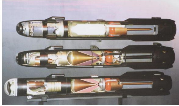
1. kép AGM-114M Hellfire II repeszromboló harcírészsel (felül), AGM-114K tandem kumulatív harcírészsel (középen), AGM-114L Longbow Hellfire (alul) [12]
