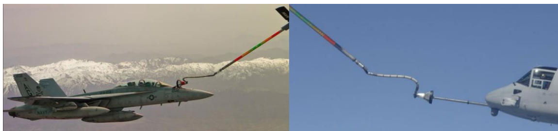
18. ábra F-18E és V-22 légi utántöltése teleszkópikus töltőcsőre épített hajlékony tömlős kúppal [13]
