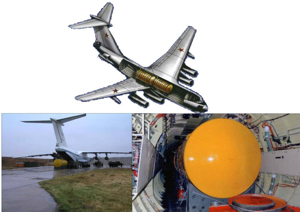
30. ábra Utántöltő tartály beemelése és elhelyezése, rögzítése a törzsben [23]
