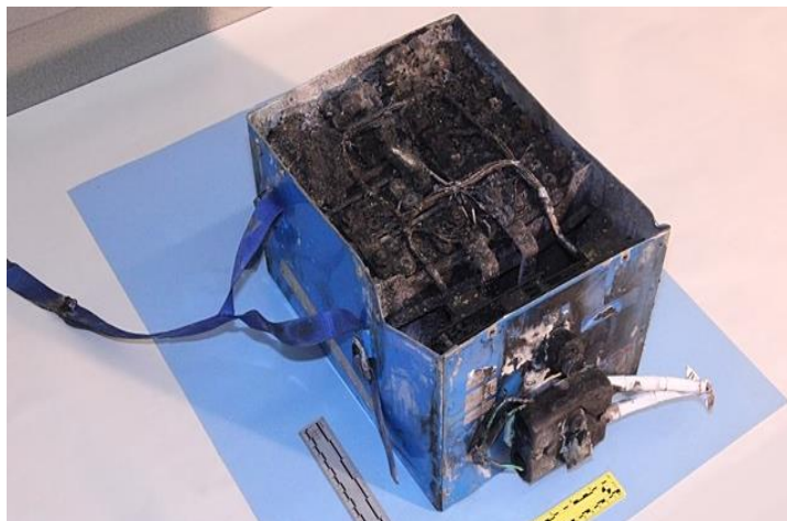
39. ábra B-787 repülőgép lítiumos akkumulátora repülés közben bekövetkezett robbanása után [12]
