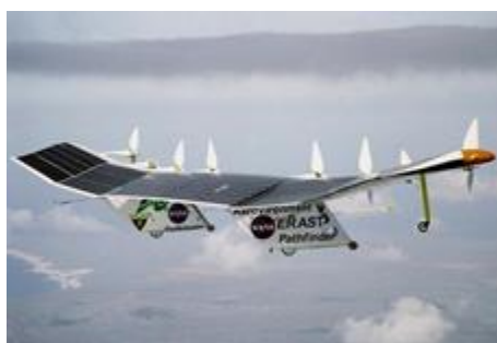
14. ábra a NASA első napelemmel működtetett villanymotoros kísérleti repülőgépe 1998-ban [NASA]
