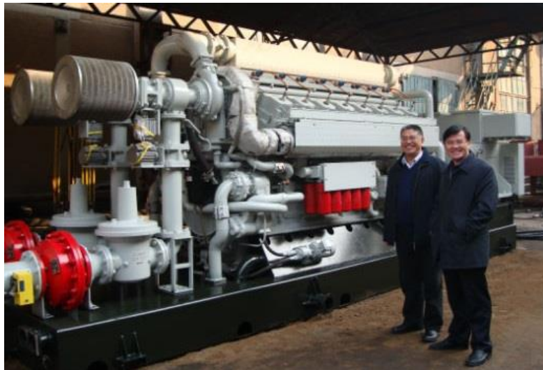
36. ábra Metánnal működő helyi elektromos energiát előállító erőmű [fotó: equipnet.ru]
