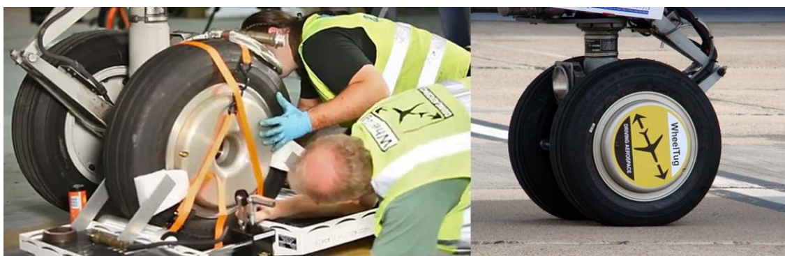
32. ábra A WheelTug® szerelés közben és rögzítve egy Boeing-737 orrfutó kerekén [saját montázs]
