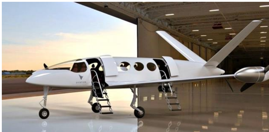
20. ábra 9 utast szállító, az Eviation Aircraft által gyártott Alice elektromos meghajtású repülőgép [42]
