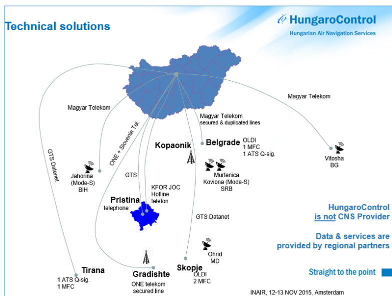
8.ábra A koszovói magaslégtéri irányításhoz szükséges adatkapcsolatok (Forrás: HungaroControl)
