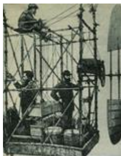
13. ábra Siemens villanymotorral felszerelt Tissandier léghajó gondolája [7]
