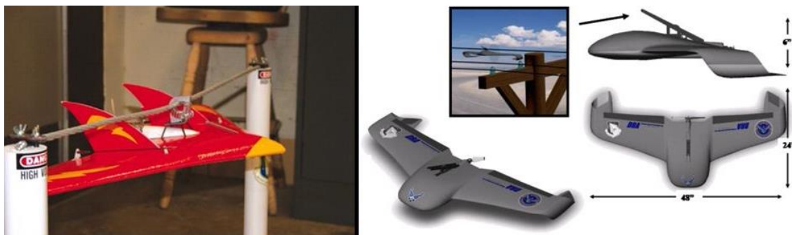
5. kép Pilóta nélküli repülőgépek energia felvétele elektromos távvezetésekről, balról-jobbra: PLUS prototípus, Devil Ray [13]
