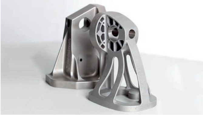
21. ábra: Ugyanaz az alkatrész hátul hagyományos, elöl 3D nyomtatási eljárással
