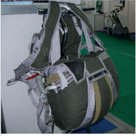
10. ábra: Sz-4U típusú mentőejtőernyő Forrás: Polyot – Paraborne equipment. Rescue parachutes. Rescue steerable parachute system, type S-4U. Online: www.expo21xx.com/nautica21xx/18543_st3_watersports/default.htm
