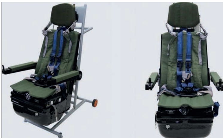
16. ábra: A Mi-28 és Ka-60 helikopterek személyzetei részére készített Pamír típusú energiaelnyelő ülés Forrás: Zvezda gyári tájékoztató. Online: www.zvezda-npp.ru/ru/node/122A
