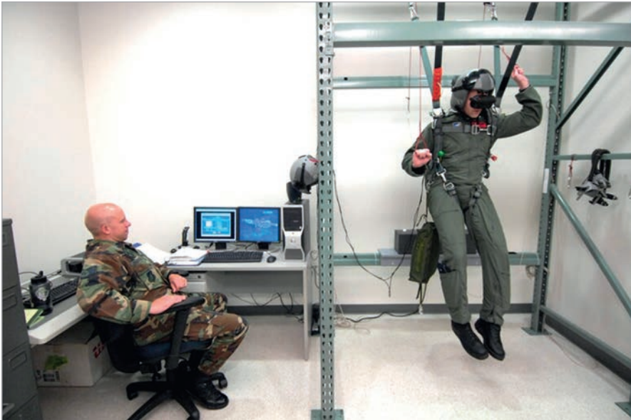
22. ábra: Napjaink amerikai repülő-hajózáinak egyik mentőejtőernyős szimulátora (Hickam Air Force Base, Hawaii, USA). A képzés valóságűségét jól szemlélteti az USAF-nál rendszeresített BA-22 típusú személyi mentőejtőernyő-hevederzet, valamint az ahhoz rögzített, a pilóta oldalán lógó egyéni túlélőcsomag is Forrás: Virtual technology enhances training for aircrews . 2006. Online: www.af.mil/News/Article-Display/Article/129527/virtual-technology-enhances-training-for-aircrews/
