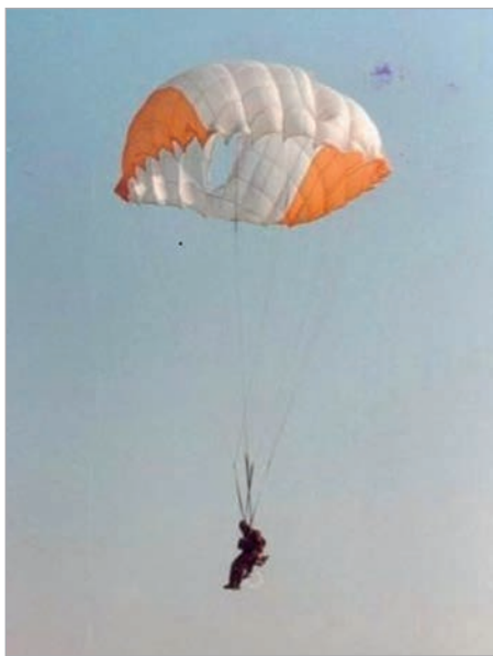
8. ábra: Sz-4U típusú pilóta-mentőernyő légi alkalmassági vizsgálata
