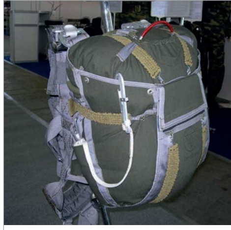
11. ábra: PN-58/3 típusú mentőejtőernyő Forrás: Polyot – Paraborne equipment. Rescue parachutes. Rescue parachute system, type PN-58 series 3. Online: www.expo21xx.com/nautica21xx/18543_st3_watersports/default.htm
