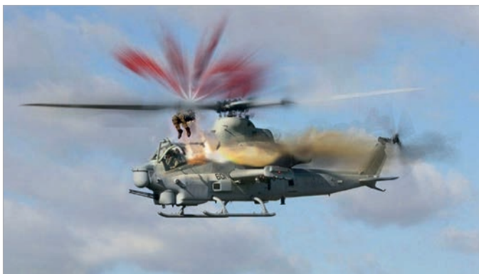
15. b) ábra: AH-1 típusú helikopter kísérleti vészelhagyása katapultüléssel, a forgószárnylapátok között Forrás: Airplane/helicopter ejection. Online: https://hu.pinterest.com/keithmonville/airplanehelicopter-ejection/
