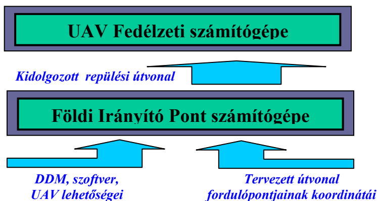
3. ábra: Az útvonal számítógéppel támogatott tervezési folyamata
