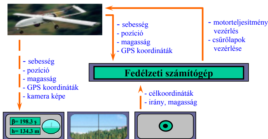
2. ábra: UAV irányítása fedélzeti számítógép támogatásával
