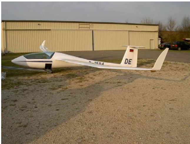
9. ábra. Ventus 2bx vitorlázó-repülőgép winglettel.
