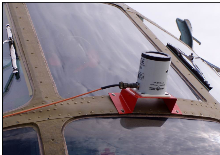
7.ábra: Mi-8 helikopterre elhelyezett optikai érzékelő
