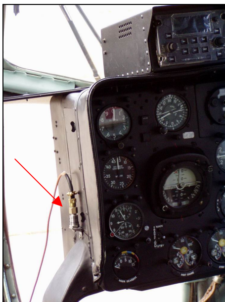
11.ábra: Műszerfalon és a fülkeajtón lévő érzékelők
