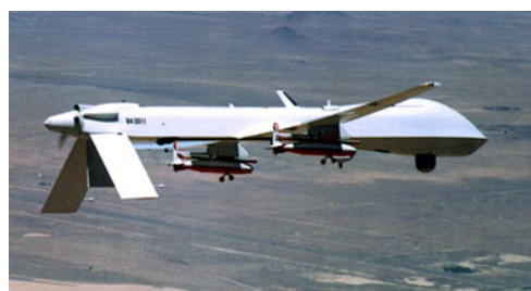
Hellfire rakétákkal felszerelt Predator MQ-1
