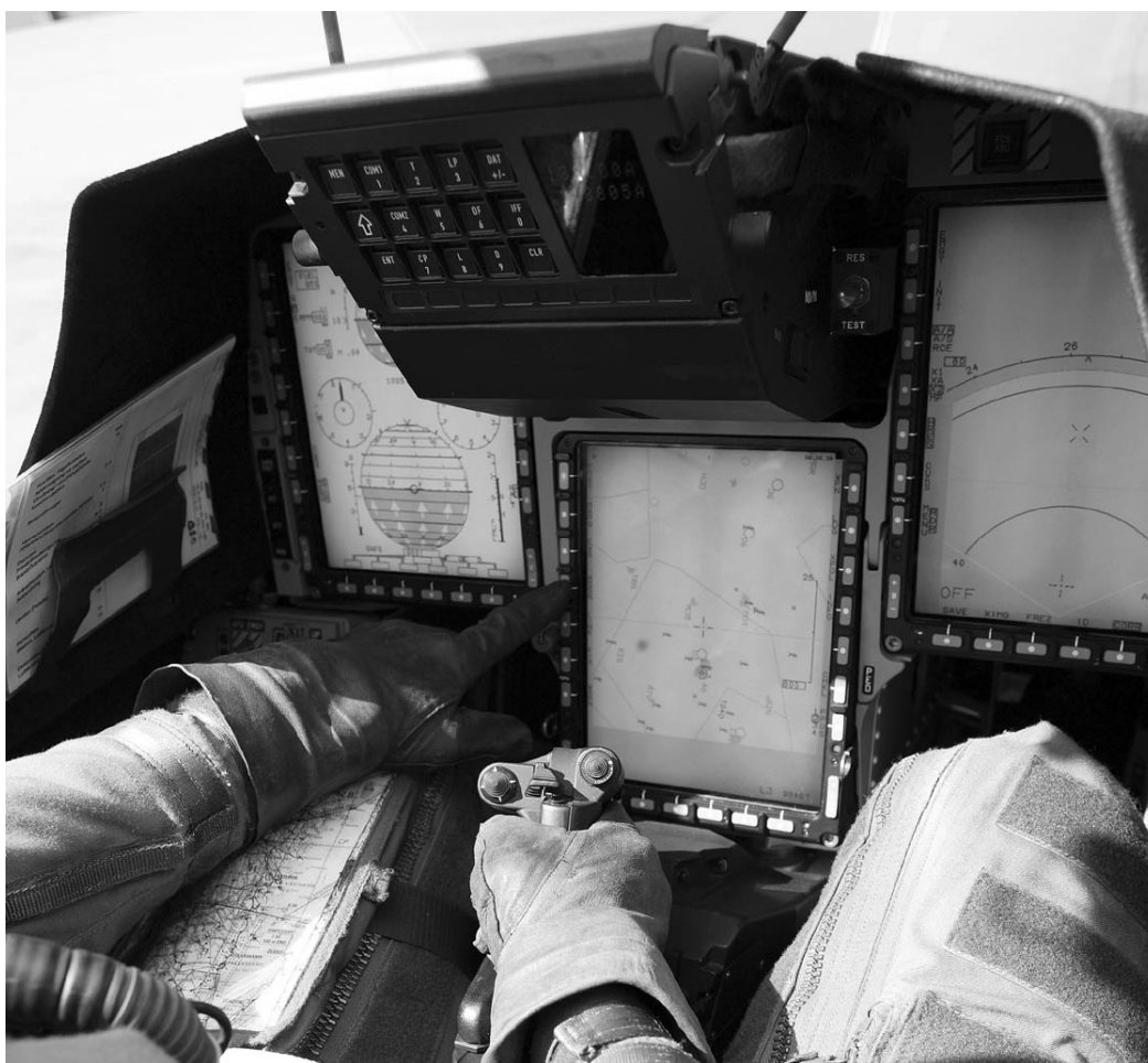
1. ábra A második generációs Gripen pilótafülkéje
