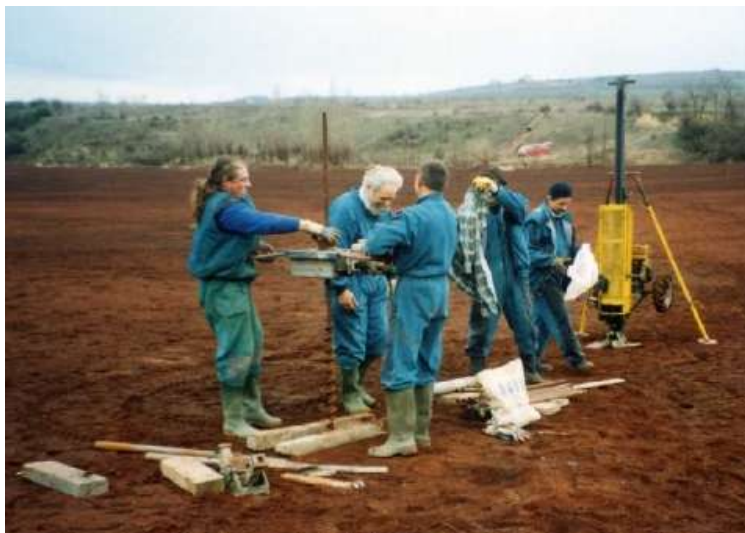
1. ábra. Mintavétel Borro típusú talajfúró berendezéssel
