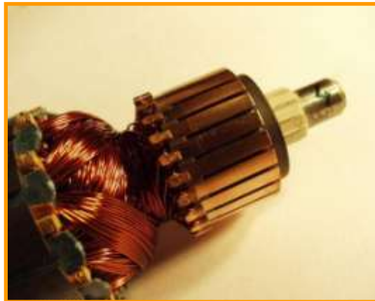
4. ábra. Vizsgált villamos forgórész
