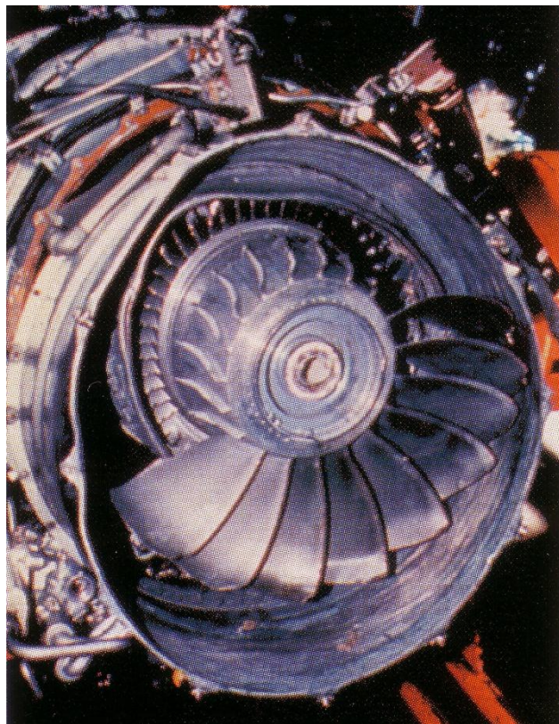
2. ábra. Madárral történt ütközés eredménye gázturbinán
