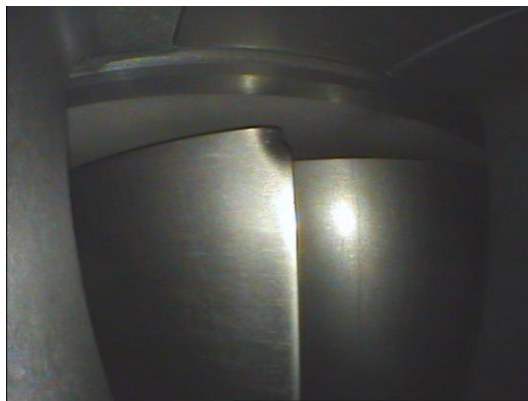
6. ábra Endoszkópos felvétel a turbina lapát sérüléséről
