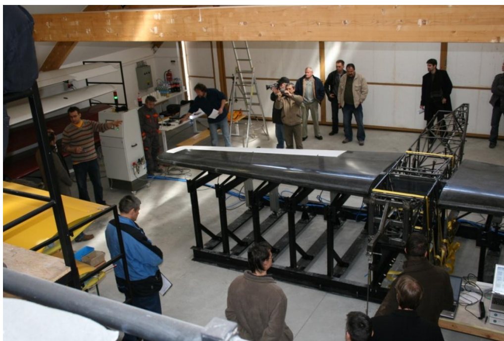
23. ábra – CORVUS RACER 540 szerkezete a szilárdsági bevizsgáláskor
