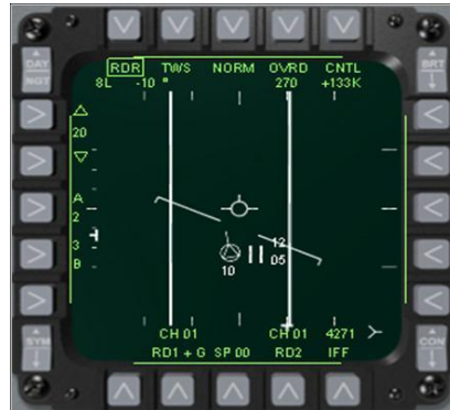
3-3. A Grifo-L radar és egy példa a „követ miközben keres” (Track While Scan) üzemmód kijelzésére
