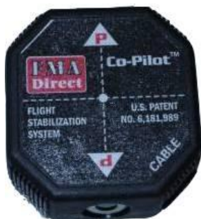
3. ábra Az FMA rendszer IR szenzora
