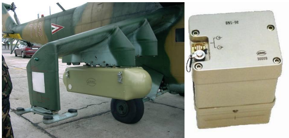
3. ábra Légi sugárfelderítő konténer a MI-24-en (balra) és BNS-98 (jobbra)
