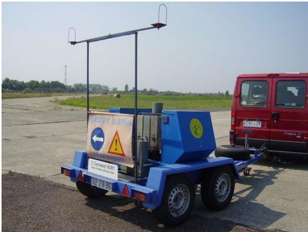
2. ábra. Kéttengelyes Dynatest 8081 HWD Debrecen Nemzetközi Repülőtér futópályáján.
