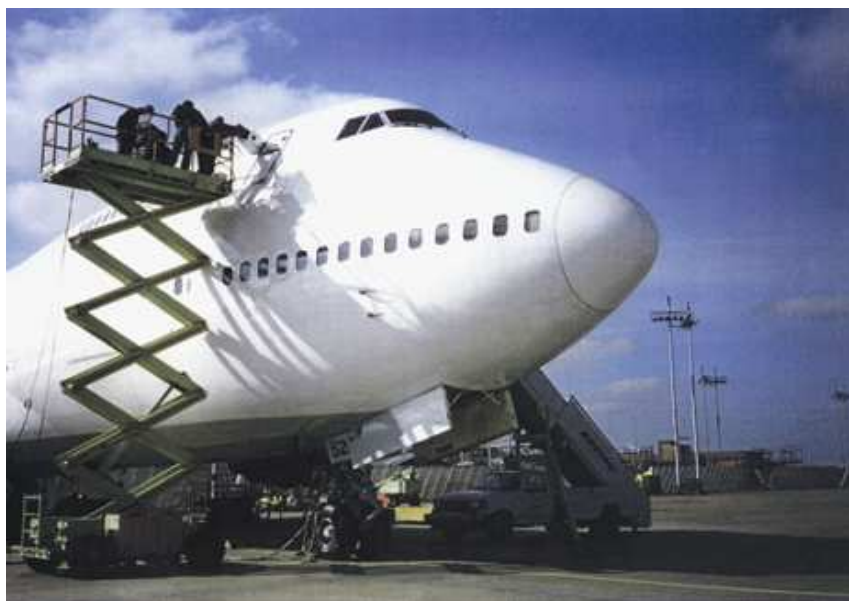
3. kép. B747 vizsgálata optikai gerjesztésű termo-kamerás rendszerrel 3
