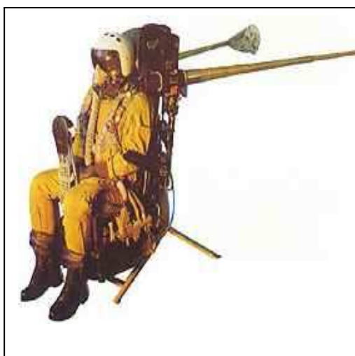
9. és 10. ábra. A K-36 típusú katapultülés és a Buran pilótafülkéjébe beépítésre tervezett módosított változata
