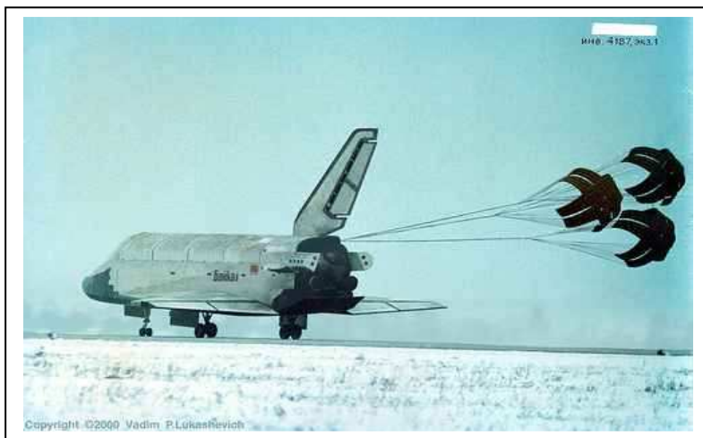
7. és 8. ábra. A Burán fékező ejtőernyőinek hármass fűrtje és a fékejtőernyő gondolája a függőleges vezérsík alatt
