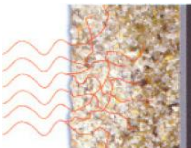
7. ábra. A TABRESshield panel elnyeli a rezgéseket 9
