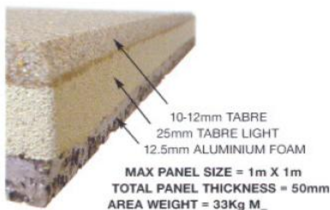
6. ábra. A TABRESchield panel rétegfelépítése 8
