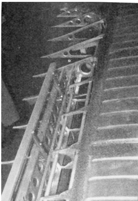
Az R-25/2 szárnya a külső borítás nélkül
