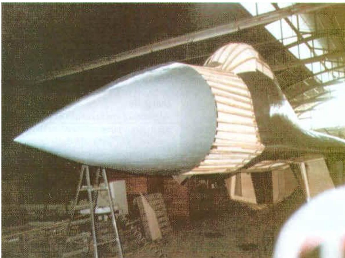
6. ábra. MiG – 29 repülőgép makett építése (Déli-szláv válság)
