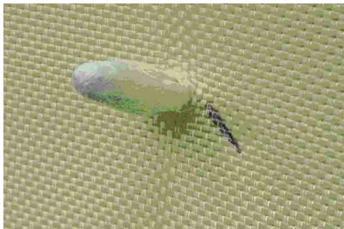
7. ábra Elemi szálak szakadása idegen tárgy behatására [9]
