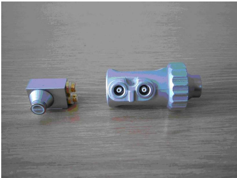
A 15. ábrán alkatrész vizsgálatokhoz alkalmazható ultrahangos vizsgálófejek láthatóak.
