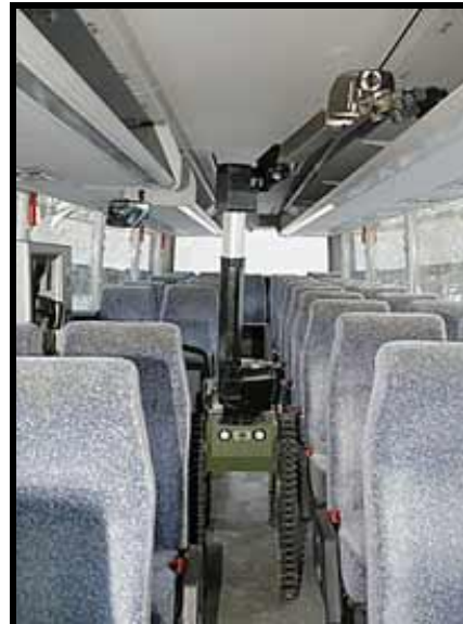
11. kép. TELEMAT robottal történő detektálás repülőgépen és transzfer buszon 23
