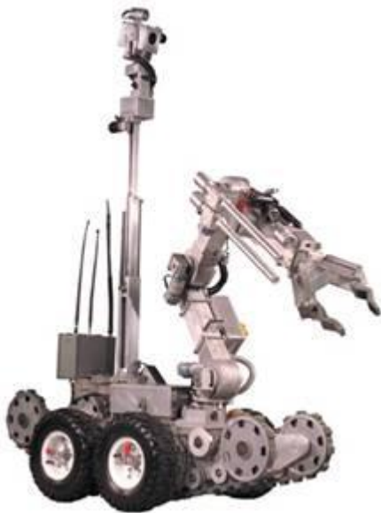
3. kép. Az ANDROS F-6A nehéz tűzszerezés robot 13
