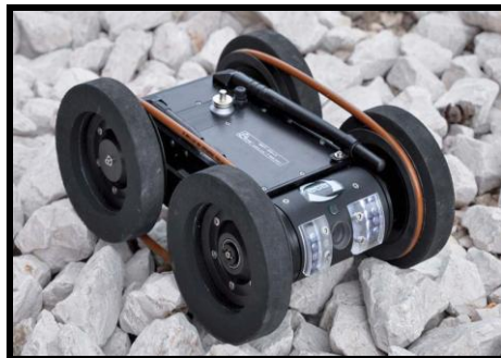
6. kép. INBOT csomagolási helyzete, táv vezérelhető személyzet nélküli terep jármű, vezérlő egység 16
