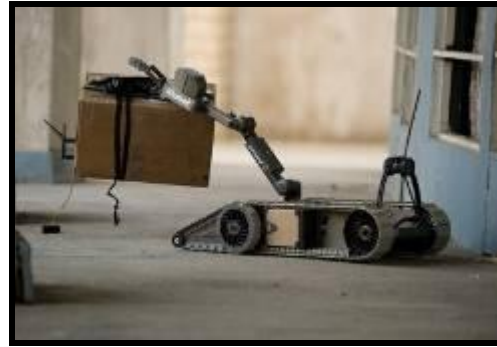
2. kép. 310 SUGV mobil harcászati robot. 5
