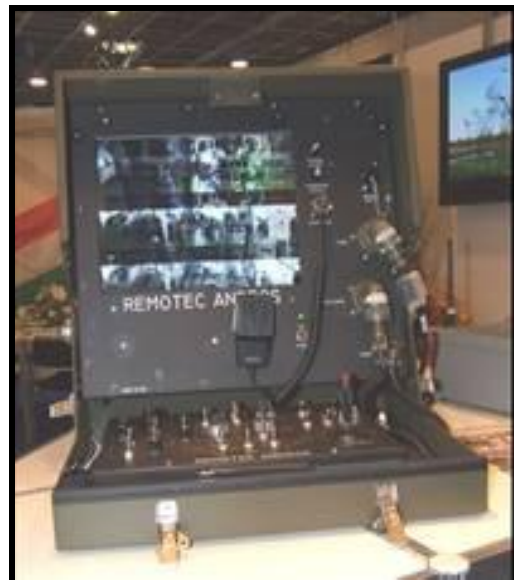
4. kép. Az ANDROS F-6A nehéz tűzszerezés robot vezérlő egysége 14
