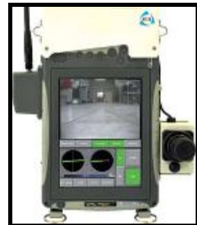
6. kép. INBOT csomagolási helyzete, táv vezérelhető személyzet nélküli terep jármű, vezérlő egység 16
