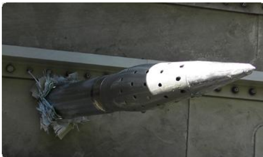
7. ábra. Oltódárda: a gép törzsén áthatolva a furatokon keresztül juttatja az oltóanyagot a törzsbe 16
