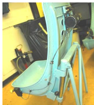
14. ábra második pilóta ülésén a bowden tok rögzítése
