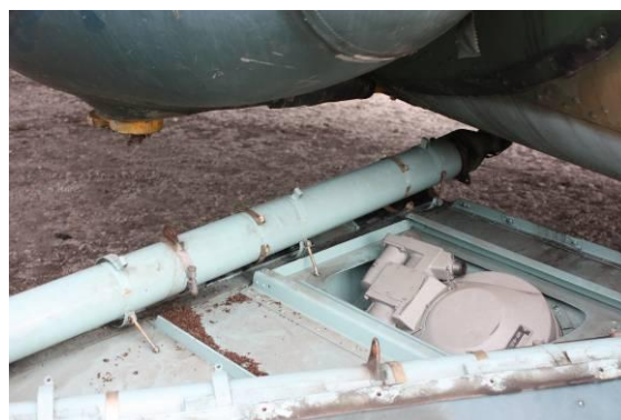
2. ábra A PRF-4 fényszóró és mozgató mechanizmusa az áramvonalazóba beépítve Mi-8-as típusú helikopteren
