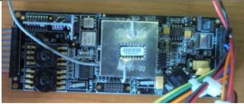
5. kép Az MP2028 alaplapja két nyomásmérő érzékelővel és a GPS vevővel 12
