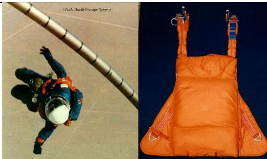
11. és 12. ábra A Space Shuttle egyéni ejtőernyős mentőrendszerének tesztelése a kísérleti ejtőernyős ugrás során [31]
