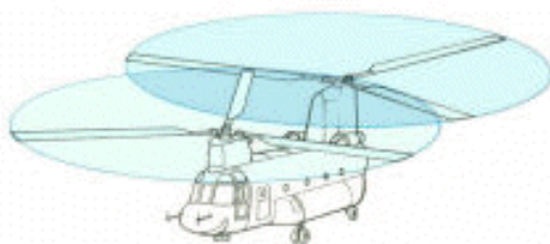
14. ábra Tandem elrendezésű forgószárny [42]
