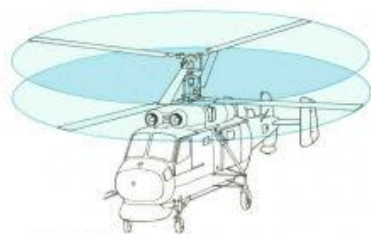
13. ábra Koaxiális forgószárny elrendezés [41]
