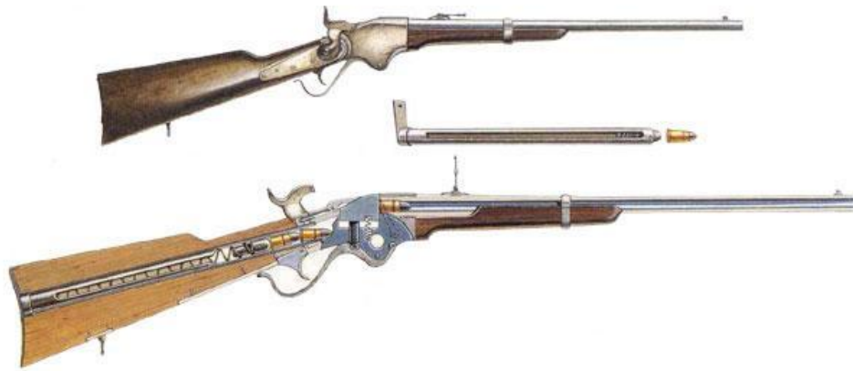
7. ábra Spencer-féle ismétlő puska, tusába ágyazott lőszeradogatóval [12]
