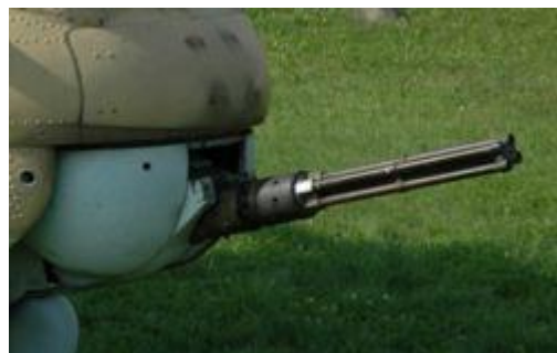
14. ábra Többcsövű-azonos töltényűrű JakB-12,7-es géppuska egy Mi-24-es harci helikopteren [14]
