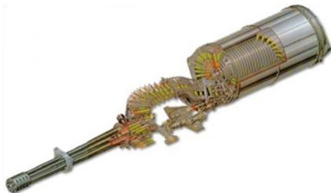
15. ábra Egy GAU-8/A Avenger 30 mm-es gépágyú a speciális tölténytároló dobbal (szerkezeti rajz) [15]
