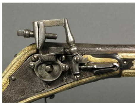
5. ábra Kerekelsütő szerkezet egy angol pisztolyon (1500-as évek közepe) [10]
