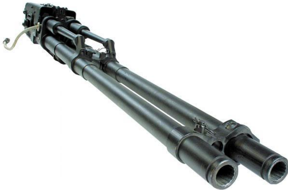
13. ábra GS-23-as ikercsövű géppágyú [13]
