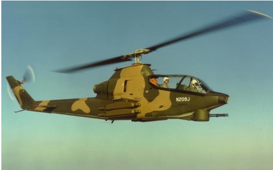
8. ábra. Napjaink egyik moder harci helikoptere az AH-1W/Z Super Cobra, amelynek az orrába egy mozgatható 20 mm-es Gatling gépágyú található [22]
