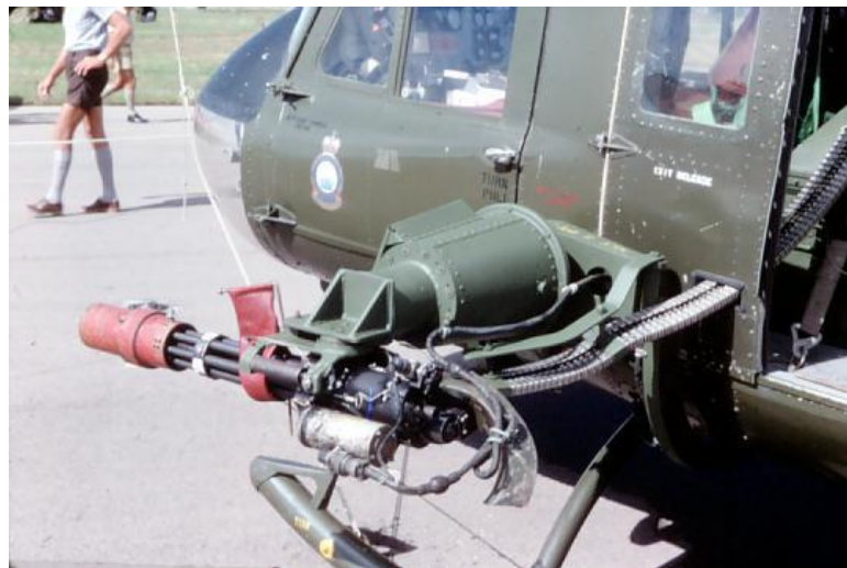
10. ábra. UH-1 (Huey) szállító helikopter oldalán felszerelt egy szabadságfokú géppuskája [8]
