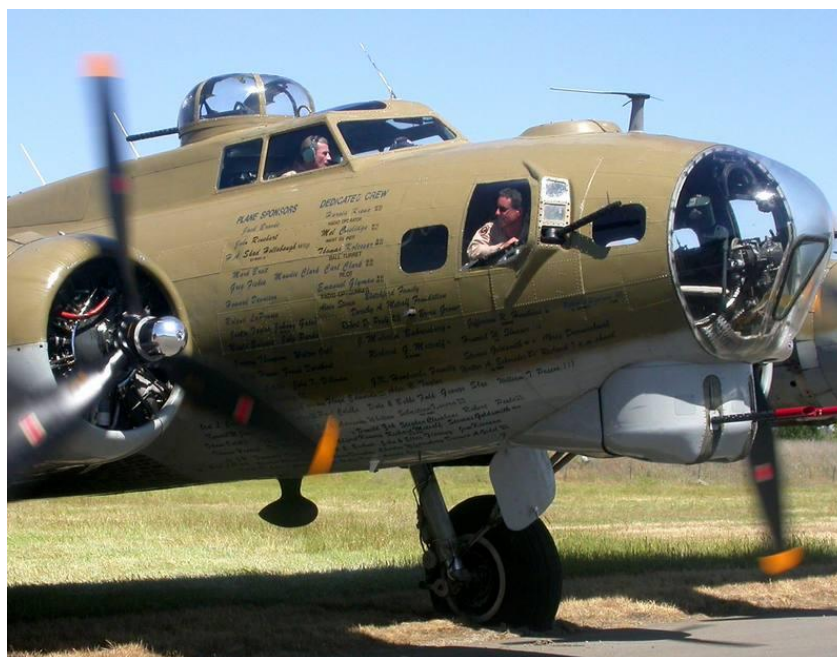
5. ábra. B-17-es Amerikai bombázó jobboldali oldalsó orrlövésze és az orrában kialakított forgatható lőtornya [15]
