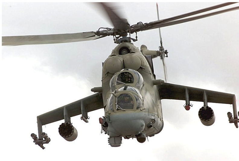
4. ábra Mi-24 harci helikopter IPS szűrővel felszerelve 7
