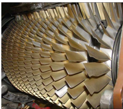
1. ábra Erodált kompresszorlapátok 2
