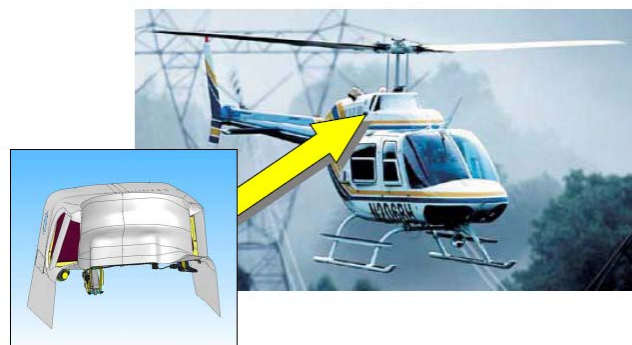
20. ábra Bell 206B/OH-58A/C IBF szűrővel felszerelve 25
