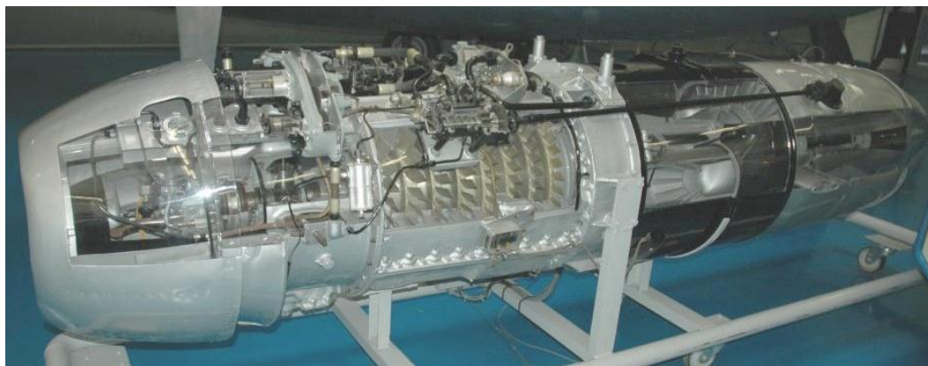
5. ábra A Me 262 erőforrása a Junkers Jumo 004 típusú hajtómű [9]
