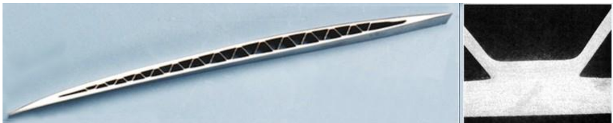
39. ábra A második generációs Rolls-Royce Trent ventilátor lapát belső struktúrája [53]
